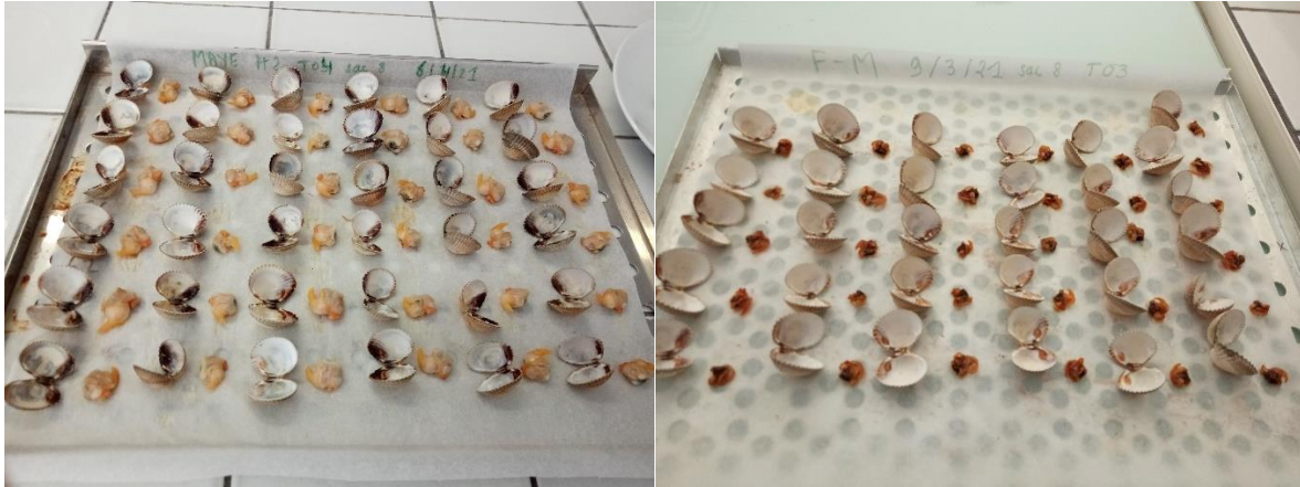
Figure 11 : Disposition des coques avant le passage à l'étuve (à gauche) et rendu après 48 heures (à droite)
