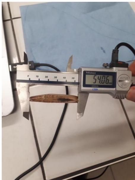
Figure 8 : Mesure de la longueur d'un couteau au mm près à l'aide d'un pied à coulisse électronique
