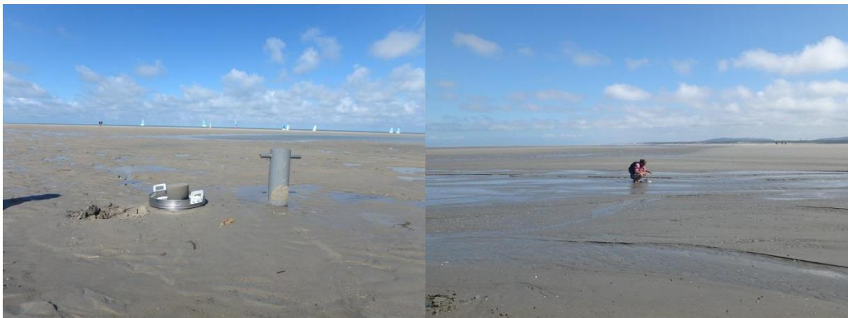
**Figure 5: Carottier à main en PVC (surface unitaire égale à 0,029 m<sup>2</sup>) à gauche, tamisage sur 1 mm à droite**
