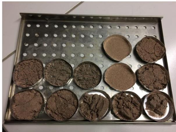
**Figure 4: Capsule de sédiment après calcination pour l'obtention de la matière organique**
