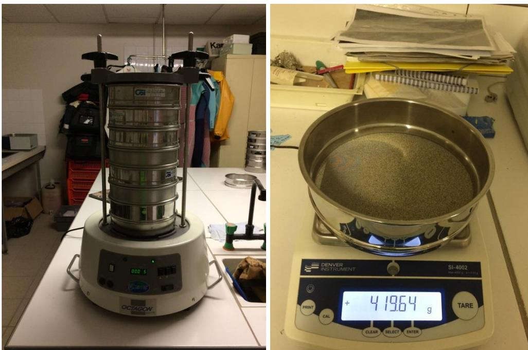
**Figure 3: Tamiseuse avec colonnes AFNOR (à gauche) et pesée des sédiments après tamisage (à droite)**
