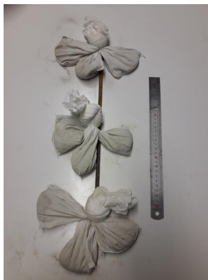
Figure 39 : Fixation des sacs aux piquets en métal à 3 hauteurs différentes (2cm, 15 cm, 30 cm)
