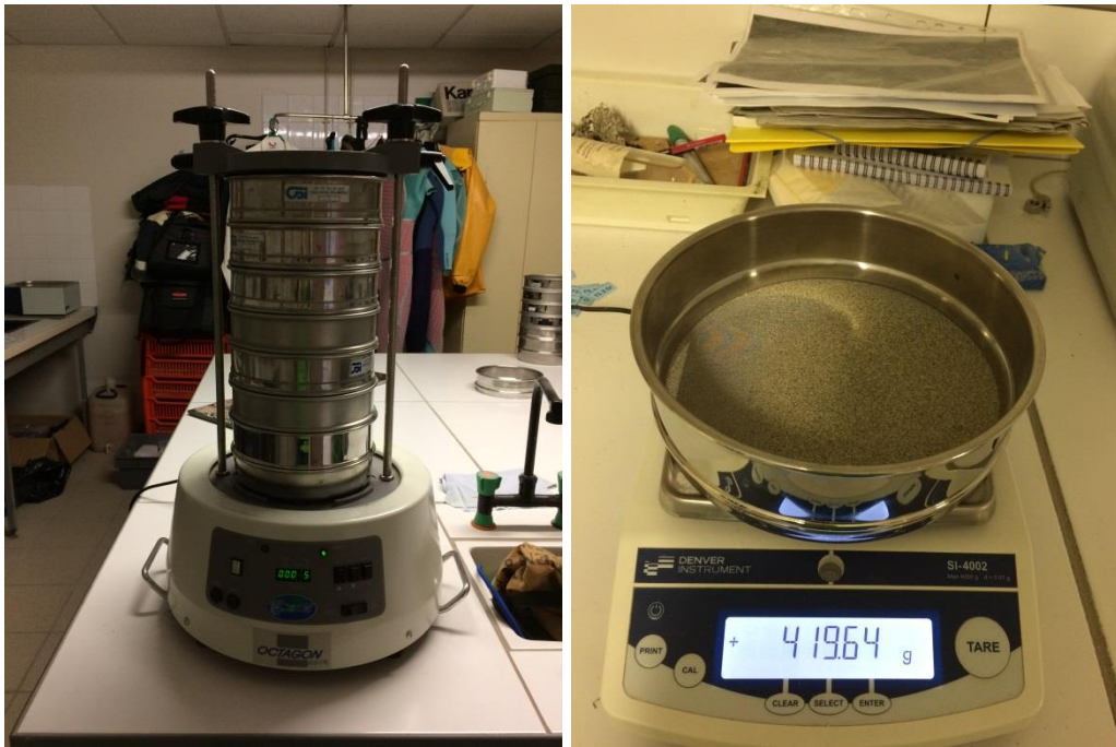
Figure 23 : Tamiseuse avec colonnes AFNOR et pesée des sédiments après tamisage
