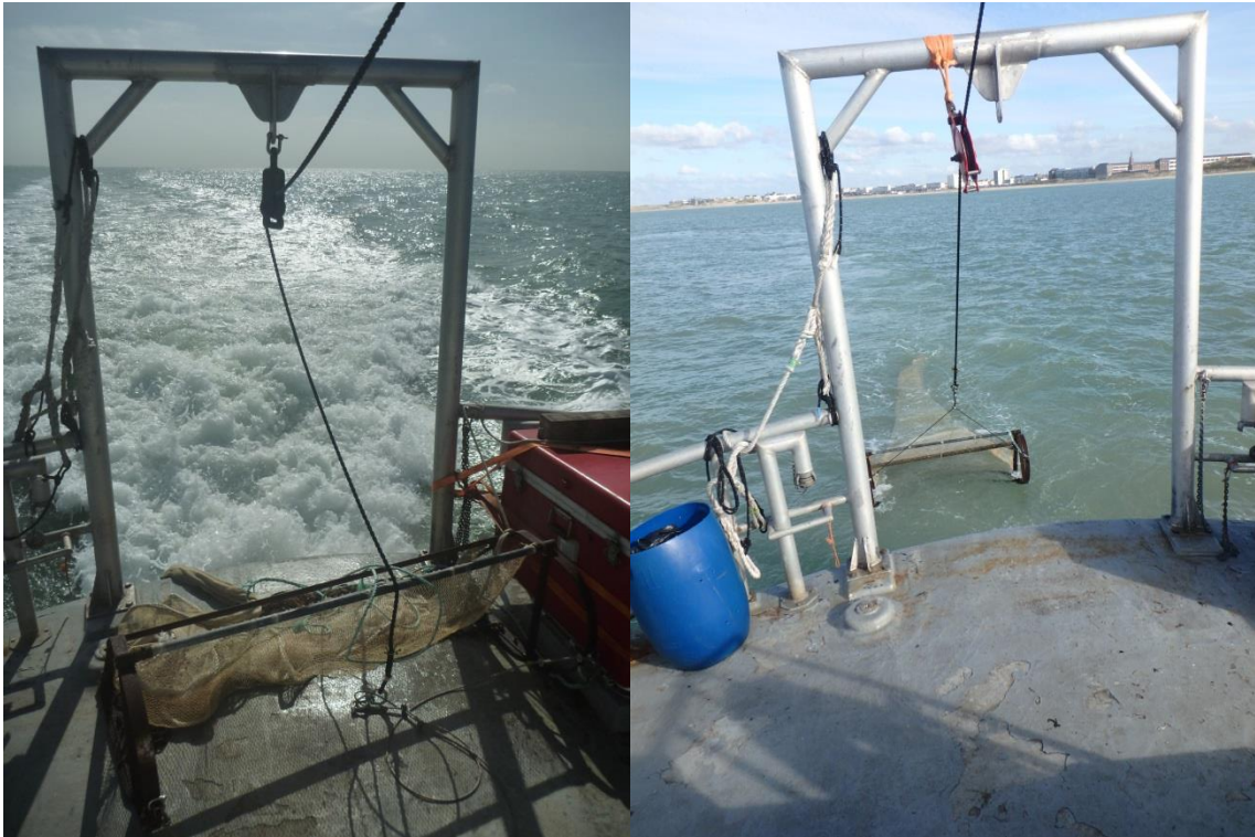
Figure 17: Chalut à perche de 1,5 m d'ouverture utilisé dans le cadre du projet FIAC à bord du navire « Ville de Paris »
