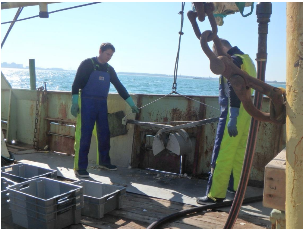
Prélèvements à la benne Van Veen lors des campagnes de suivi du CNPE de Gravelines – benthos subtidal
