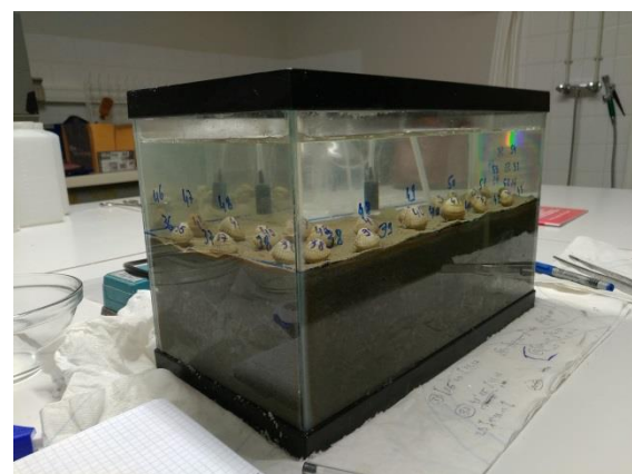
Test d'enfouissement des coques en conditions contrôlées
