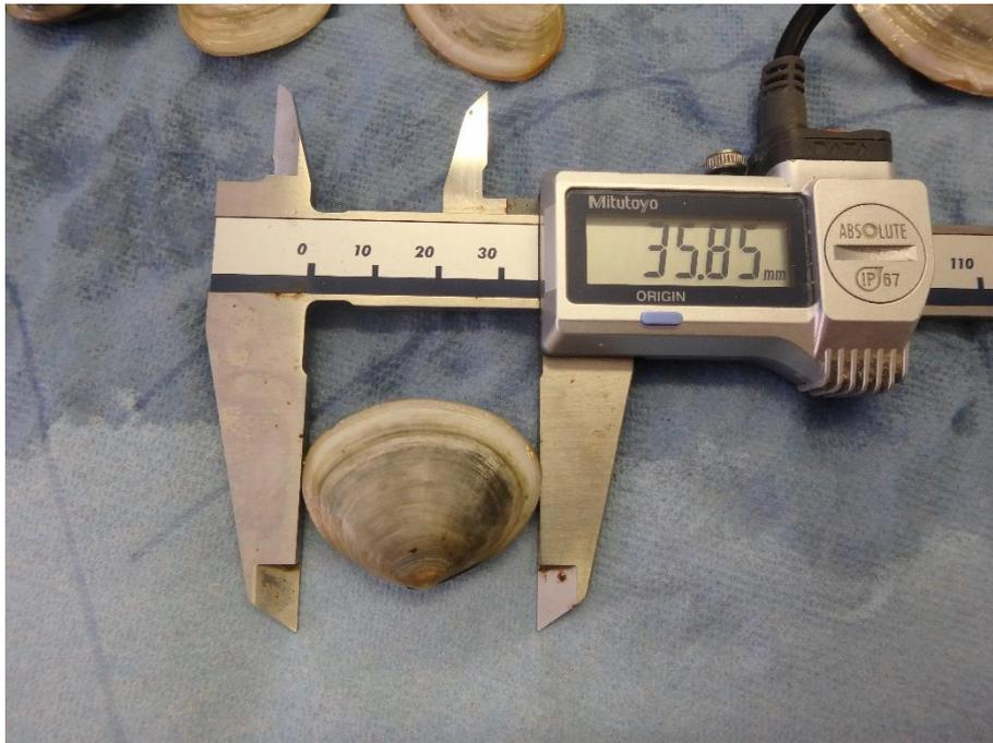
*Figure 2 : Mesure de la longueur d'une scrobiculaire*
