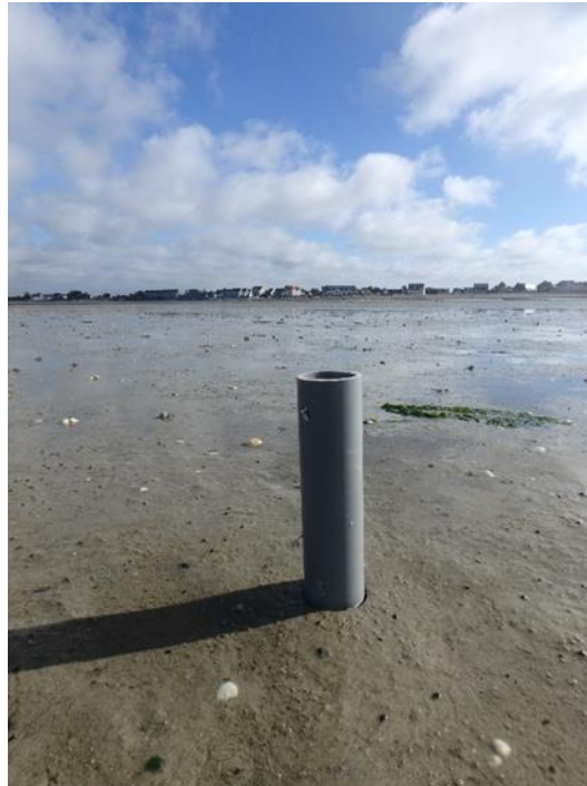
Figure 102 : Carottier de 4 cm de diamètre extérieur sur 5 cm de profondeur utilisé pour les prélèvements de granulométrie (3 carottes) et de matière organique (1 carotte).
