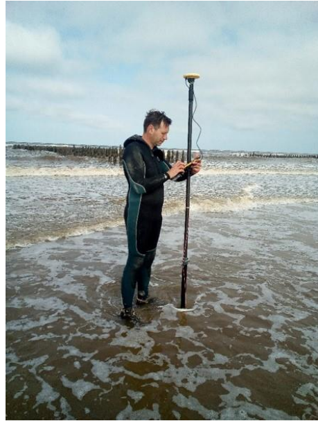
Préparation du DGPS pour acquisition de la topographie au niveau des concessions mytilicoles
