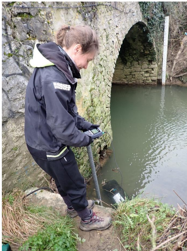
Figure 70 : Relève des paramètres environnementaux à l'aide de la sonde sur la Slack
