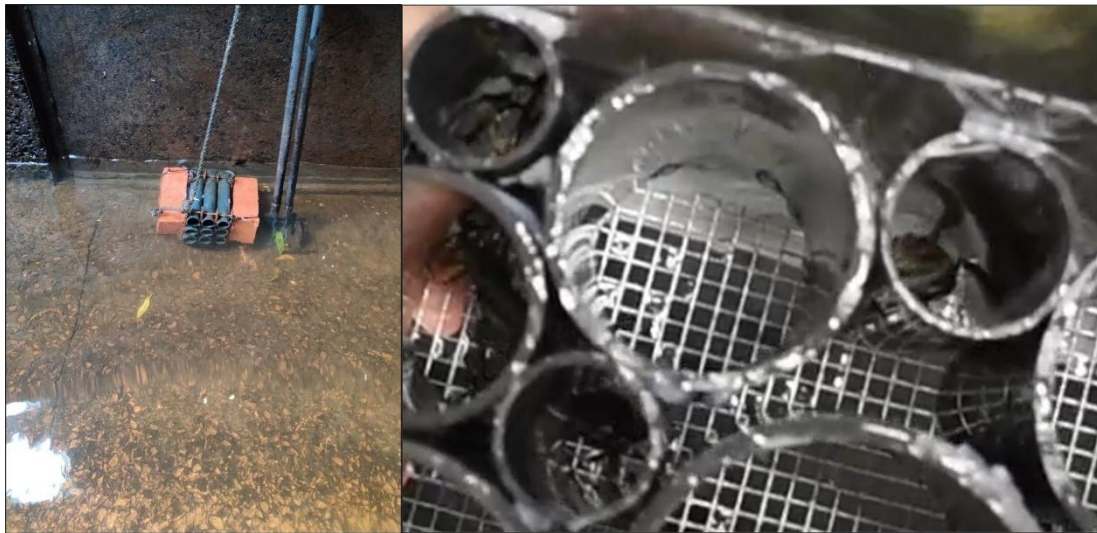
Figure 63 : Pièges à condo en action dans la passe à poisson du barrage sur le Chester au Pays de Galles et crabes chinois logés dans les tubes (© Oscar Norton Jones)
