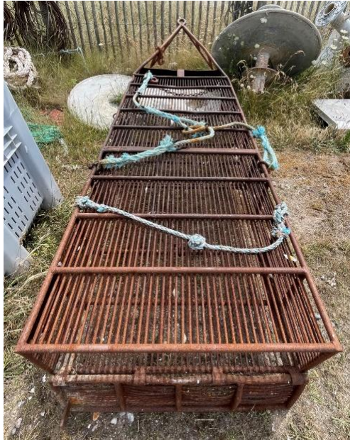
Figure 6 : Drague à petits bivalves utilisée pour l'évaluation du stock d'amandes de mer au large de la baie de Somme, juin et juillet 2025 (© schéma George J.P., 2005).
