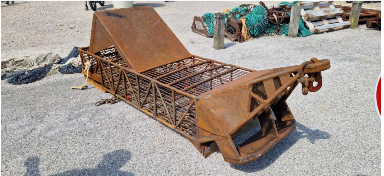
Figure 7 : Drague à amandes de mer utilisée pour les prélèvements.
