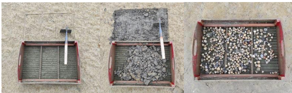
Figure 2 : Prélèvements de terrain à l'aide d'une veinette modifiée (outil de travail des pêcheurs à pied de coques professionnels, sur laquelle un tamis d'1 cm de maille est installé).
