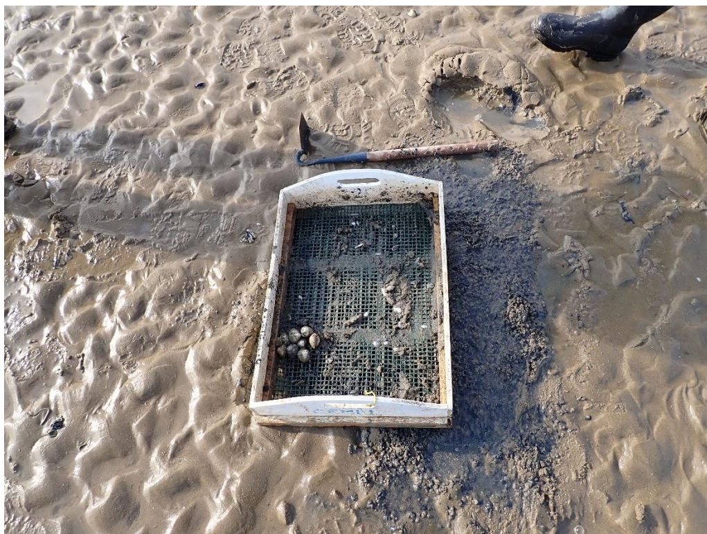
Figure 2 : Veinette modifiée pour échantillonner les coques
